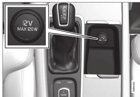
12 V strømuttak i tunnelkonsoll, forsete.
