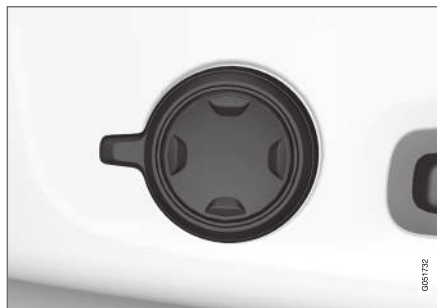
Multifunksjonsbryteren, i biler med 4-veis korsryggstøtte*.
