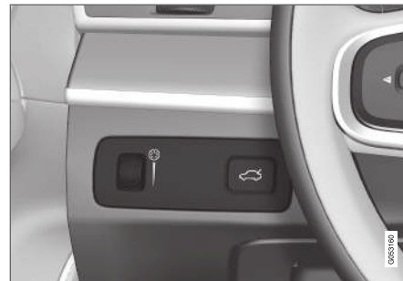
Ratt (til venstre) for justering av lysstyrken i kupeen.
