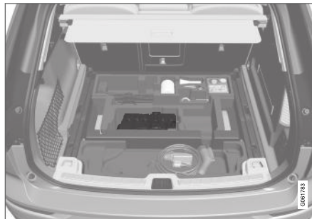
Startbatteriet sitter i bagasjerommet.
