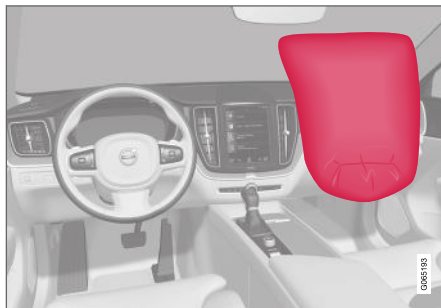
Kollisjonspute på passasjersiden i forsetet.
