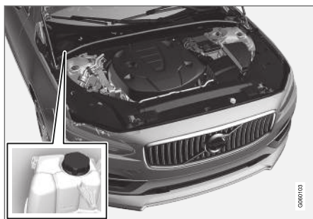
Ekspansjonsbeholder for kjølesystemet, bil med venstre-ratt.
