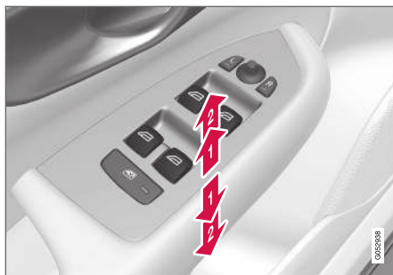
Regulering av vindusheiser.
