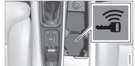
Varmistustukijan sijainti tunnelikonsolissa.
