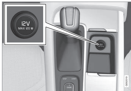
12 V:n sähköliitäntä tunnelikonsolissa, etuistuin.
