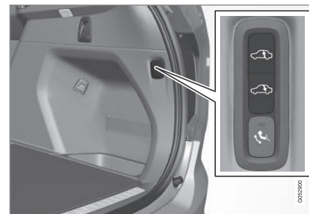
Auton takaosan nostamisen/laskemisen säädin.
