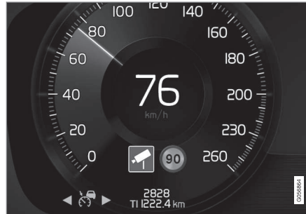
Nopeuskameravaroitus kuljettajan näytössä.
