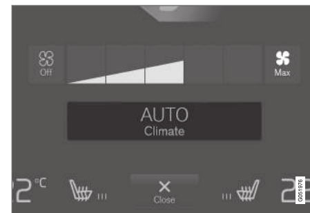
Botão da regulação automática na vista de climatização.
