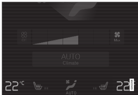
Botões de temperatura na linha da climatização 16, 15 .
