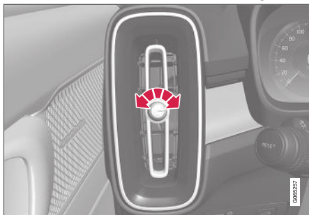
Seletor rotativo da boca de ventilação 3 .
