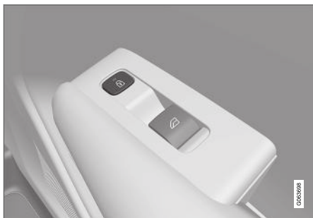
Botão para trancagem na porta traseira com luz indicadora.
