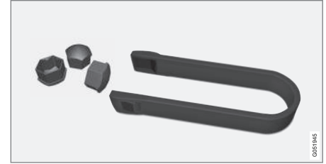
Tekerlek civataları üzerindeki plastik kapakları çıkartma aleti.
