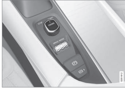
Tünel konsolundaki çalıştırma düğmesi.
