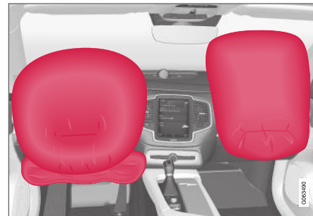
Coussins gonflables avant latéraux de conducteur/passager.
