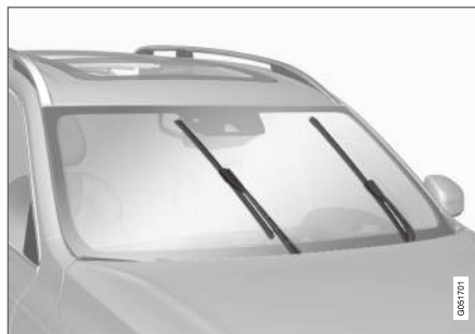
Balais d'essuie-glaces en position d'entretien.
