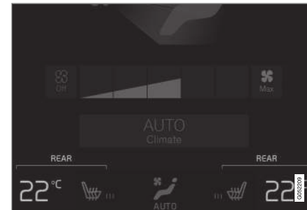
Boutons de température dans l'onglet Climatisation à l'arrière de la vue Climatisation.
