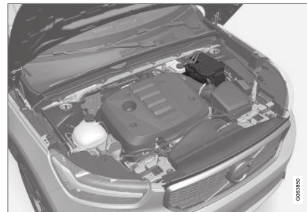
La batteria di avviamento si trova nel vano motore.
