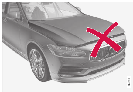
Cofano non completamente chiuso.
