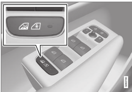
Pulsante di attivazione e disattivazione elettrica.
