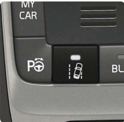
Se o automóvel estiver na iminência de cruzar uma linha lateral, a LKA actua no volante com um ligeiro binário para conduzir o automóvel de volta para a sua faixa. Se o automóvel cruzar uma linha lateral a LKA avisa o condutor com vibrações no volante.
