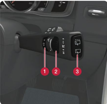
Desloque a alavanca para baixo para iniciar os limpa pára-brisas e para cima para uma passagem única.
