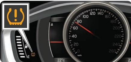
É sempre necessário proceder à calibragem após a mudança de pneu ou alteração da pressão do pneu. Quando a luz acende (⚠) é necessário calibrar o sistema. Proceda do seguinte modo:
