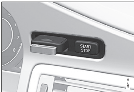
Cerradura de contacto con llave extraíble, botón de arranque y parada (encontrará más información en la página 65).
