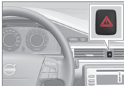
Luces de emergencia
