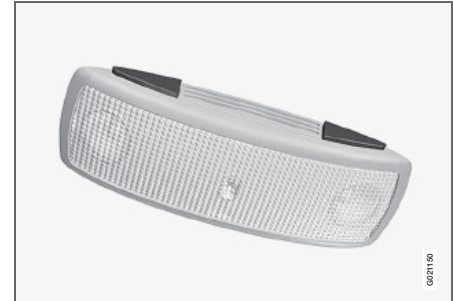
Iluminación trasera del techo
