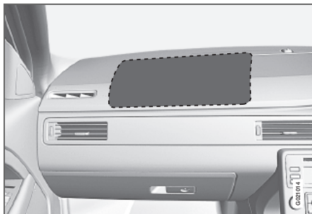
Ubicación del airbag del lado del acompañante en un vehículo con volante a la derecha
