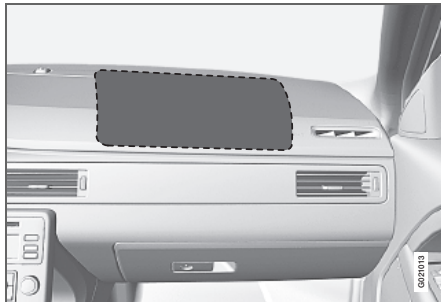
Ubicación del airbag del lado del acompañante en un vehículo con volante a la izquierda
