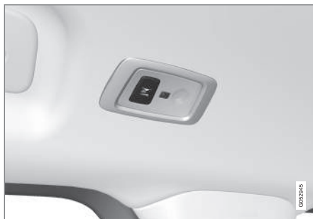
I bil med panoramatak* finns två lampenheter, en på vardera sida av taket.
