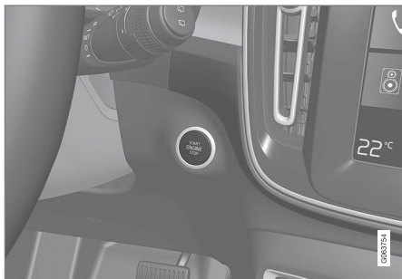
Emplacement de la commande de démarrage.
