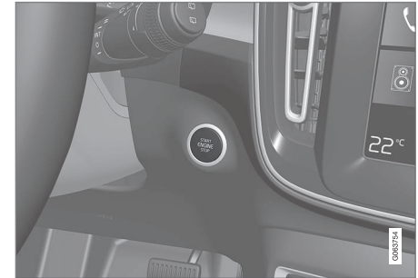
Emplacement de la commande de démarrage.
