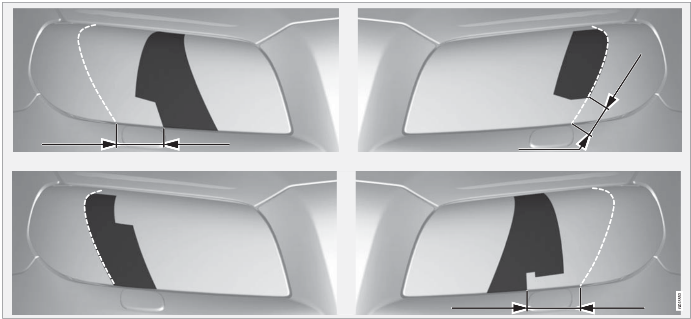
上図:左ハンドル専用、テンプレート A および B。次図:右ハンドル専用、テンプレート C および D。
