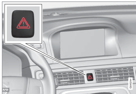
非常点滅表示灯ボタン
