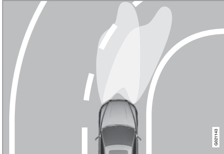
アクティブヘッドライトを解除したときの照射パターン(左)と作動したときの照射パターン(右)
