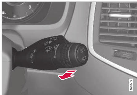
Sproeifunctie, rechter stuurhendel.
