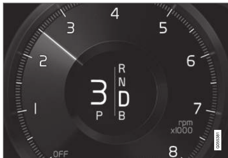
Bestuursdisplay bij het schakelen met de stuurpaddles.
