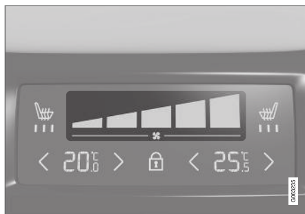
Ventilatorregeling op klimaatpaneel achter op tunnelconsole.
