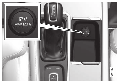
12V-aansluiting in tunnelconsole, voorin.
