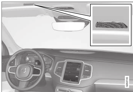
Microfoon van de stembediening
