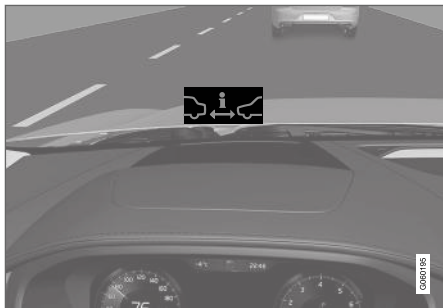
Symbool voor afstandswaarschuwing onder aan de voorruit 41 .
