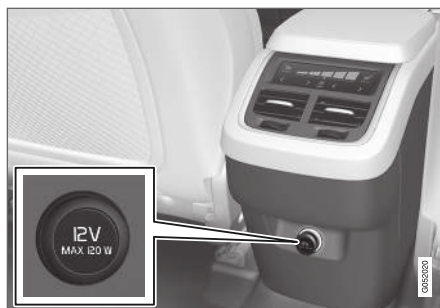
12V-aansluiting in tunnelconsole, tweede zitrij.
