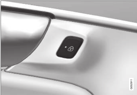
Knop voor vergrendelen in achterportier met led.
