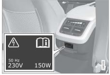
مقبس كهربائي بقوة ٢٣٠ فولت في كونسول النفق، بالمقعد الخلفي. يمكن استخدام المقبس الكهر بائي مع العديد من الملحقات بقوة ٢٣٠ فولت، مثل أجهزة شحن الهاتف الجوال والكمبيوتر المحمول.
