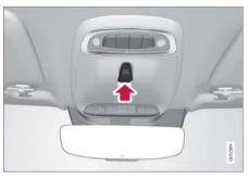
يتم تشغيل فتحة السقف بواسطة زر التحكم الموجود في السقف. يتم تنشيط عناصر التحكم إذا كان النظام الكهربائي للسيارة في وضع الإشعال I أو II.
