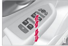
تشغيل النوافذ الكهربائية.
