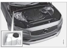
خزان التمدد لسائل التبريد، سيارة ذات عجلة قيادة يسرى.
