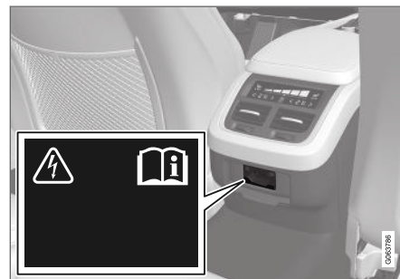
Prises électriques dans la console de tunnel, siège arrière.
