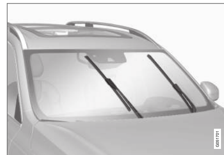
Balais d'essuie-glaces en position d'entretien.
