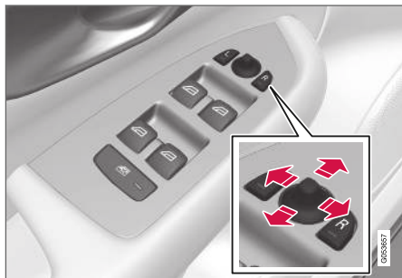
Commandes du rétroviseur latéral.
