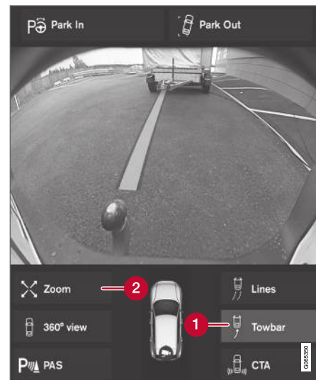
Barre de traction avec ligne de trajectoire.
