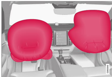
Coussins gonflables avant latéraux de conducteur/passager.
