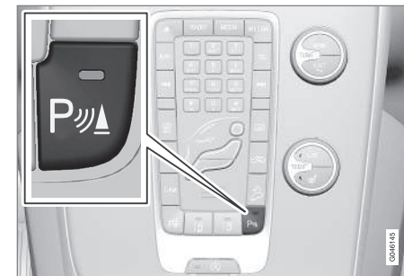
Conexión y desconexión de los sensores de aparcamiento asistido y CTA 30 .
