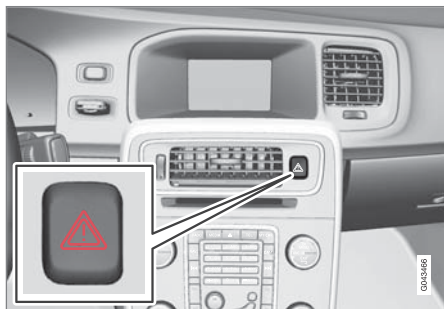
非常点滅灯ボタン
