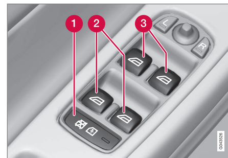
Pannello di comando nella portiera del conducente.
