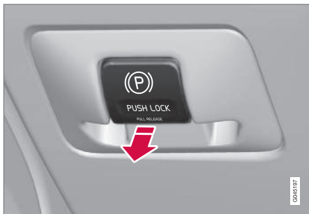
Comando del freno di stazionamento - distacco.
