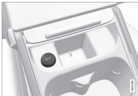
Presa da 12 V nel tunnel, sedile anteriore.
