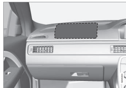
Posizione dell'airbag lato passeggero nelle automobili con guida a destra.
