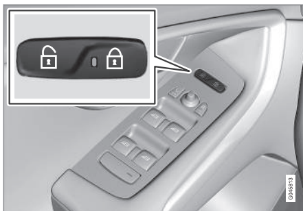
Pulsante della chiusura centralizzata
