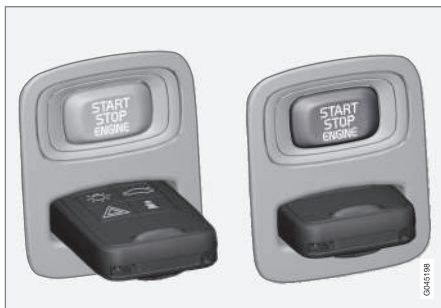
Blocchetto di accensione con chiave telecomando estratta/inserita.
