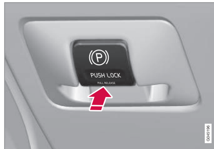
Comando del freno di stazionamento - applicato.
