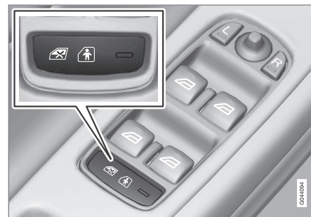
Pannello di comando nella portiera del conducente.
