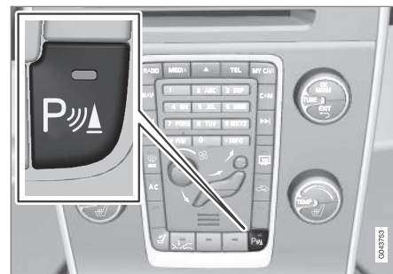
ON/OFF per Assistenza al parcheggio.
