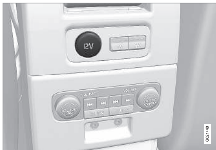
Presa da 12 V nel tunnel, sedile posteriore.
