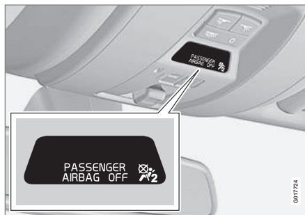
Indicazione dell'airbag lato passeggero disattivato.
