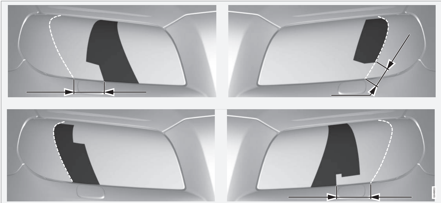
Riga superiore: automobile con guida a sinistra, sagome A e B. Riga inferiore: automobile con guida a destra, sagome C e D.
