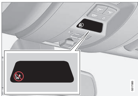
Indicazione dell'airbag lato passeggero attivato.
