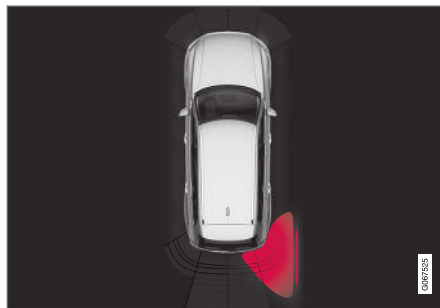
Icono encendido de CTA en el gráfico Sistema Asistente Aparcamiento de la pantalla.
