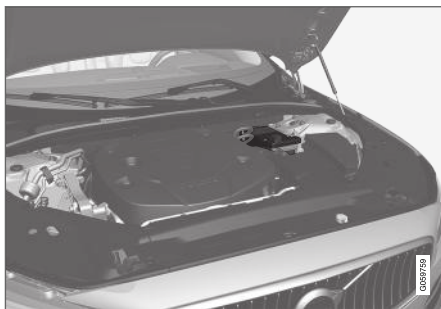
La batería de apoyo está situada en una caja al lado del amortiguador vertical.
