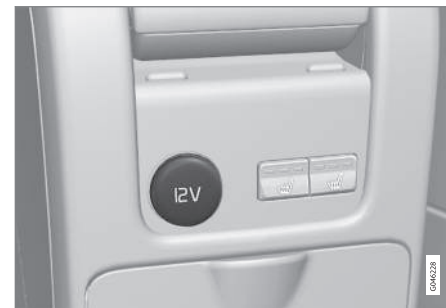
12 voltos aljzat az alagútkonzolban, hátsó ülés.
