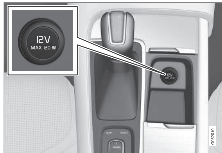
12 V strømuttak i tunnelkonsoll, forsete.
