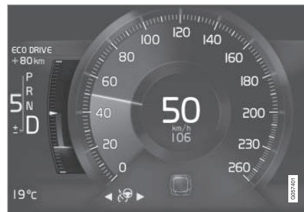
Eco-måleren i 8-tommers førerdisplay.
