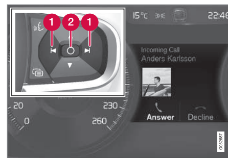
Meldinger på førerdisplayet 5 og høyre knapperad i rattet.
