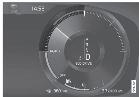
ECO-måleren på 12-tommers førerdisplay.
