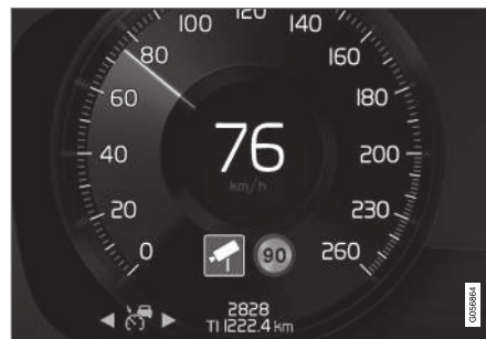
Información sobre cámaras de control de velocidad en la pantalla del conductor 111 .
