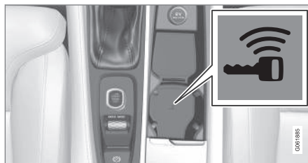
Posizione del lettore di riserva nel portalattine.
