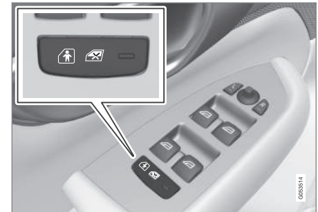
Pulsante di attivazione e disattivazione elettrica.
