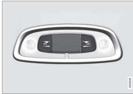
Luci di lettura sopra il sedile posteriore.
