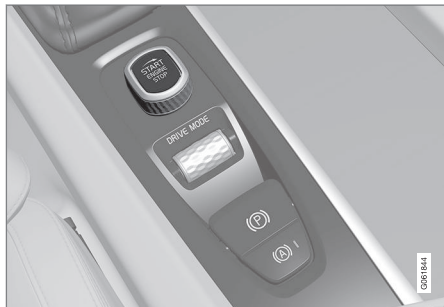
Interruttore di avviamento nel tunnel.
