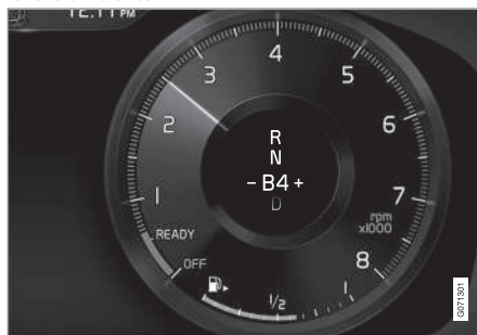
Display del conducente in caso di cambio marce con le leve al volante in modalità di cambio manuale.
