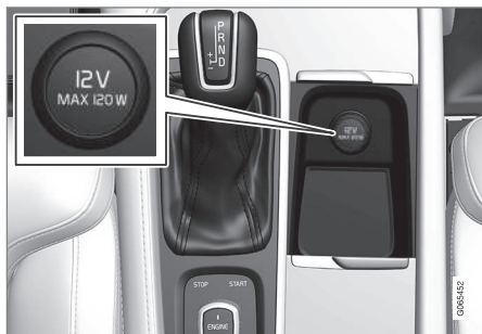
Presa elettrica da 12 V nel tunnel, sedile anteriore.
