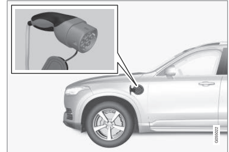
Terminale del cavo di ricarica e presa di ricarica.
