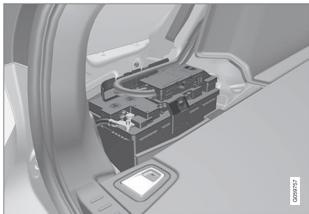
La batteria di avviamento si trova nel bagagliaio.
