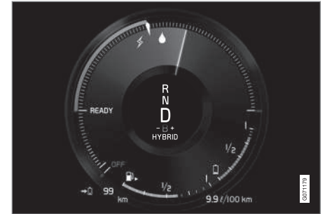
Display del conducente in caso di guida con motore elettrico e a scoppio.
