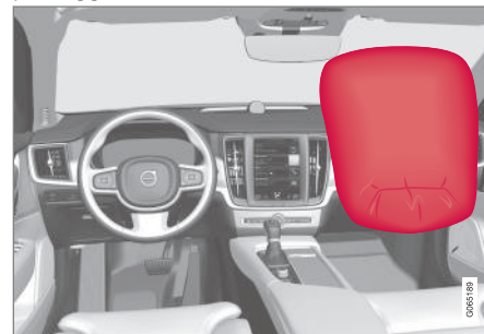
Airbag nel sedile anteriore sul lato passeggero.
