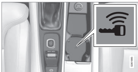
Posizione del lettore di riserva nel portalattine.
