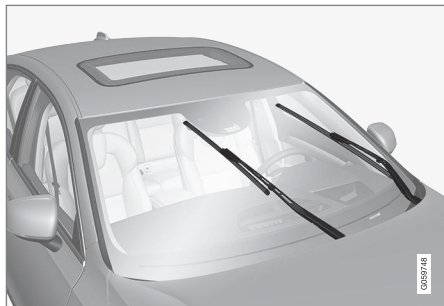
Spazzole tergicristallo in posizione di assistenza.
