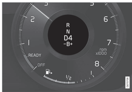
Display del conducente in caso di cambio marcia con le leve al volante.
