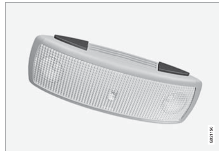
ไฟเพดานด้านหลัง
