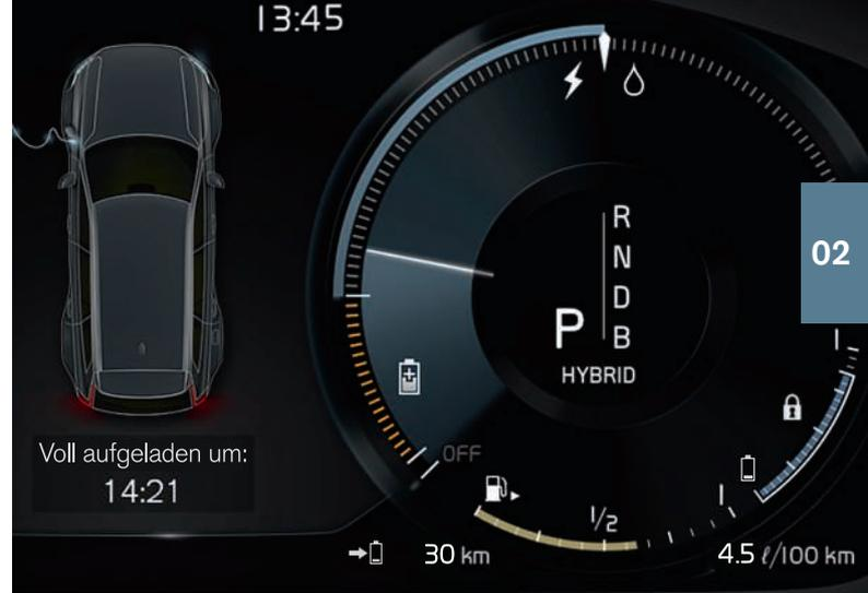
Im Modus **Charge** wird die Hybridbatterie aufgeladen, wenn sie nur noch schwach geladen ist. Im Modus **Hold** wird der Ladezustand der Batterie erhalten, sodass das Fahrzeug zu einem späteren Zeitpunkt im Elektrobetrieb gefahren werden kann.
