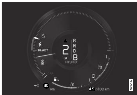
Førerdisplayet angiver opladning under elmotorbremsning.
