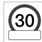
La visualizzazione di un cartello accessorio sotto forma di un riquadro vuoto sotto il segnale di velocità<sup>89</sup> sul display del conducente indica che la funzione ha rilevato un cartello accessorio con informazioni complementari per il limite di velocità attuale.
