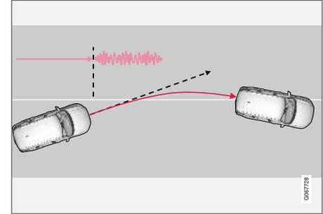
Il mantenimento corsia attivo avverte il conducente mediante vibrazioni del volante.
