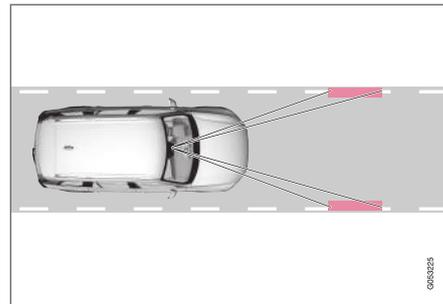
DAC rileva la posizione dell'automobile nella corsia di marcia.
