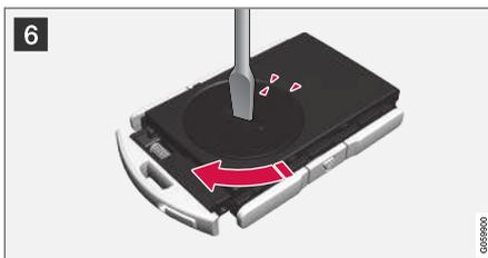
**6** Risistemare lo sportello delle batterie e ruotarlo in senso orario in modo che il segno sia allineato al testo **CLOSE**.
