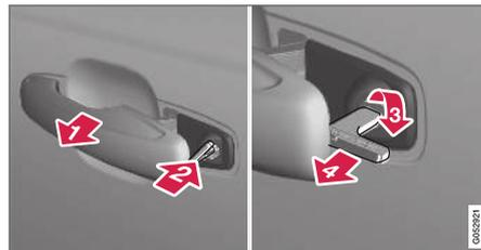
**1**▶ Portare al fincorsa esterno la maniglia della portiera anteriore sinistra<sup>9</sup>, mettendo a nudo la serratura.
