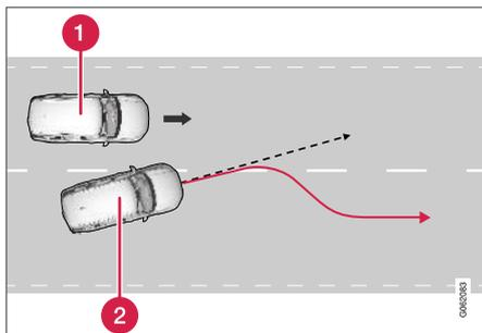
La funzione può assistere il conducente sterzando l'automobile per riportarla nella corsia di marcia.
