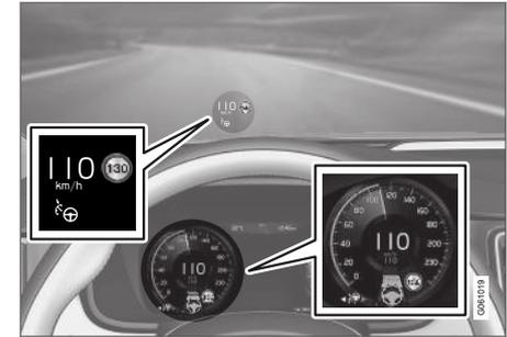
La figura precedente<sup>51</sup> mostra che il Pilot Assist è impostato per mantenere una velocità di 110 km/h (68 mph) e che non è presente un veicolo anti-stante da seguire.
