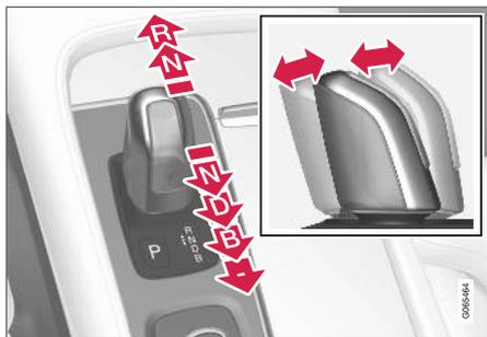
Per cambiare posizione del cambio, portare avanti o indietro la leva selettoria a ritorno automatico.
