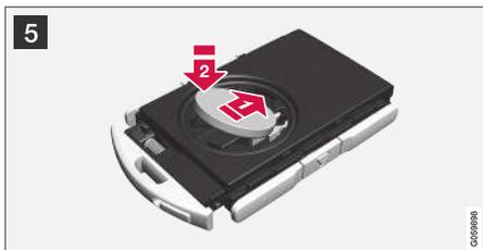
**5** Inserire una nuova batteria con il lato + verso l'alto. Non toccare con le dita i contatti della batteria della chiave telecomando.
