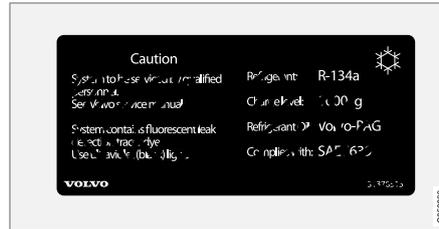
2 Etichetta sulle automobili dotate di climatizzatore contenente refrigerante R134a.
