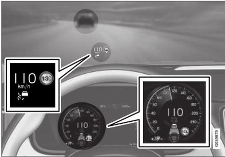
La figura precedente<sup>51</sup> mostra che il Pilot Assist è impostato per mantenere una velocità di 110 km/h (68 mph) e segue un veicolo anti-stante che mantiene la stessa velocità.
