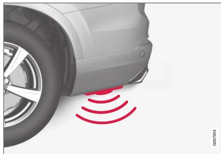
Per attivare l'apertura o la chiusura con il movimento del piede nelle automobili con skid plate, compiere il movimento di avvicinamento del piede dal lato dell'automobile. L'apertura e la chiusura sono consentite se una delle chiavi telecomando dell'automobile si trova nel campo di portata (circa 1 m - 3 piedi).
