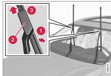
1. Sollevare il braccio dei tergicristalli quando si trova in posizione di assistenza. La posizione di assistenza si attiva/disattiva dalla videata funzioni sul display centrale ad automobile ferma con i tergicristalli disinseriti.
