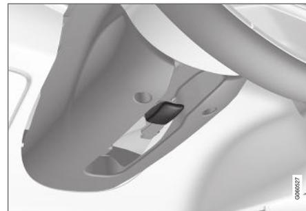
Leva per la regolazione del volante.
