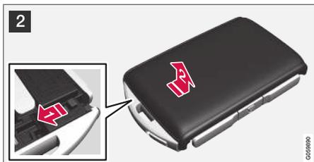
2 **1** Capovolgere la chiave telecomando, spostare lateralmente il pulsante e fare scorrere il guscio del lato posteriore verso l'alto di alcuni millimetri.
