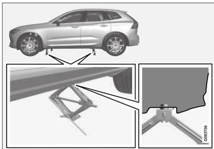
9. Sistemare il martinetto su una superficie piana, stabile e non scivolosa, sotto il punto di fissaggio da utilizzare.
