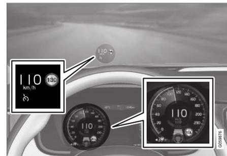
La figura precedente<sup>51</sup> mostra che il Pilot Assist è impostato per mantenere una velocità di 110 km/h (68 mph) e che non è presente un veicolo antistante da seguire.
