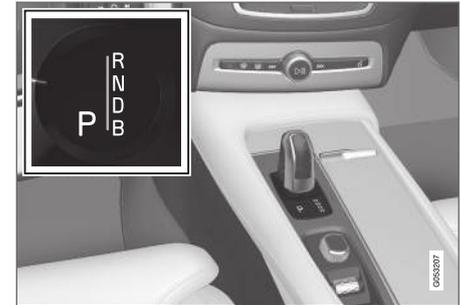
Il display del conducente segnala la posizione del cambio selezionata:
