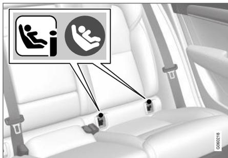
La posizione dei punti di fissaggio è indicata da simboli<sup>2</sup> sul rivestimento dello schienale.
