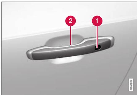
**1** Rientranza sensibile per il bloccaggio
