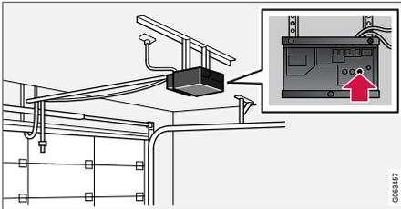
4. Localizzare il pulsante di apprendimento<sup>22</sup> del ricevitore, ad esempio del portone del garage. Solitamente si trova accanto all'attacco dell'antenna sul ricevitore.
