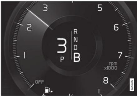
Dalla posizione **B** è possibile passare manualmente alle marce inferiori. La posizione **B** può essere selezionata in qualsiasi momento durante la marcia. L'automobile inserisce il freno motore elettrico quando si rilascia il pedale dell'accelerazione e la batteria ibrida si ricarica. La batteria ibrida può quindi essere ricaricata in più modi, cioè anche senza che il conducente prema il pedale del freno.
