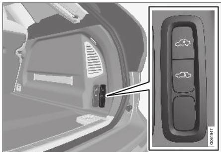
Utilizzare i pulsanti nel bagagliaio per regolare l'altezza del retrotreno e agevolare carico e scarico o le operazioni di aggancio e sgancio di un rimorchio.
