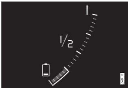
1. Se il livello di carica è alto, guidare l'automobile finché non rimane circa il 25%. Se il livello di carica è basso, ricaricare la batteria finché non si raggiunge circa il 25%.
