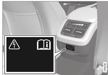
Presa elettrica nel tunnel, sedile posteriore.
