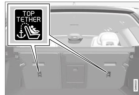
La posizione dei punti di fissaggio è indicata da simboli sul lato posteriore dello schienale.
