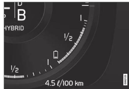
L'energia nella batteria ibrida è utilizzata per il motore elettrico nonché per raffreddare o riscaldare l'automobile. Il computer di bordo calcola un'autonomia indicativa in base all'energia nella batteria ibrida.
