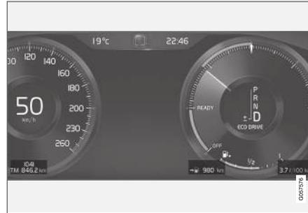
Esempio di informazioni del computer di bordo sul display del conducente.<sup>1</sup>
