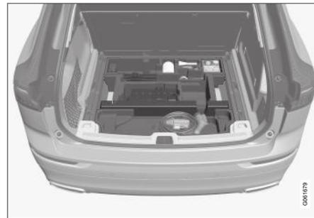
Il blocco in schiuma sotto il pavimento nel bagagliaio contiene occhiello di traino, kit di riparazione pneumatici, attrezzo di rimozione dei cappucci in plastica dei dadi delle ruote e chiavi per i dadi bloccabili delle ruote.
