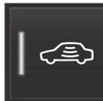
Premere il pulsante **Protezione ridotta** nella videata funzioni sul display centrale per disinserire i sensori di movimento e inclinazione al successivo bloccaggio dell'automobile.
