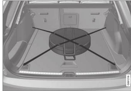
La ruota di scorta è contenuta in una custodia, che durante la marcia deve essere fissata con due cinghie al pavimento del bagagliaio. Le cinghie devono essere incrociate sulla ruota e agganciate ai quattro occhielli fermacarico dell'automobile.
