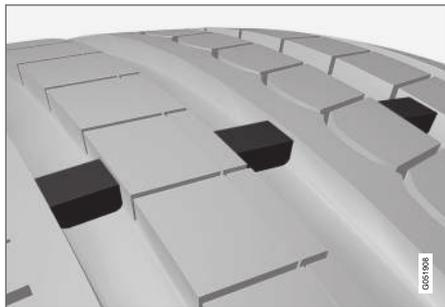
L'indicatore di usura è rappresentato da piccole bande trasversali rialzate sui solchi longitudinali del pneumatico. La sigla TWI (Tread Wear Indicator) è stampata sul lato del pneumatico. Quando il pneumatico è consumato a tal punto che rimangono solo 1,6 mm (1/16") di battistrada, queste bande sono chiaramente visibili. In tal caso, sostituire i pneumatici al più presto. Ricordare che un pneumatico con un battistrada così sottile ha un'aderenza molto scarsa in caso di pioggia o neve.
