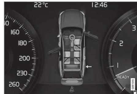
Grafica nel display del conducente con vari tipi di avvertimento. Il colore di segnalazione sulla portiera ed il portellone varia a seconda della velocità dell'auto.
