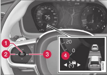
Direttamente dopo ciascuna accensione del motore, il Regolatore elettronico della velocità adattivo è nel modo di attesa. Per portarlo nel
