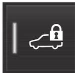
Il pulsante della funzione bloccaggio privato è disponibile nella videata funzioni sul display centrale. A seconda dello stato attuale di bloccaggio viene visualizzato
