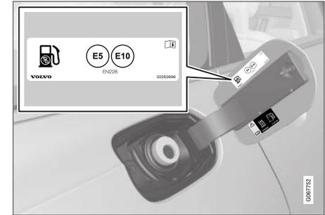
Utilizzare un carburante approvato per l'automobile, vedere l'identificatore<sup>15</sup> all'interno dello sportello del serbatoio. Per informazioni su carburanti approvati e identificatore, vedere la sezione "Benzina".
