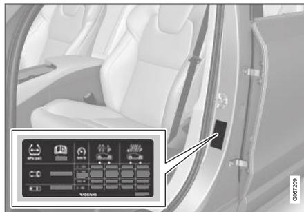
L'etichetta riporta la designazione per i pneumatici montati di fabbrica, fra cui limiti di carico e pressione dei pneumatici.
