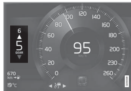
8 吋駕駛人顯示器中的換檔指示器。
