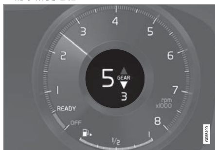
12 吋駕駛人顯示器*中的換檔指示器。
