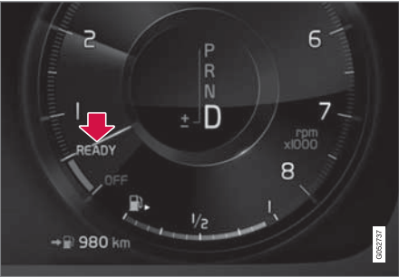
此功能啟動，引擎自動停止。 8 吋駕駛人顯示器。 符號顯示於車速錶下緣。
