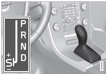
D: polohy automatického řazení. +S- : polohy manuálního řazení. S: sportovní režim.*
