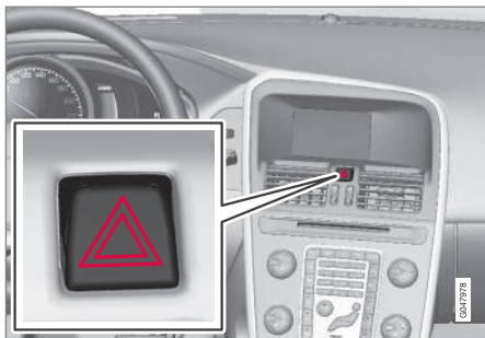
Tlačítko pro výstražnou funkci ukazatelů směru.
