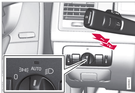
Pákový přepínač a knoflík regulace světlometů.
