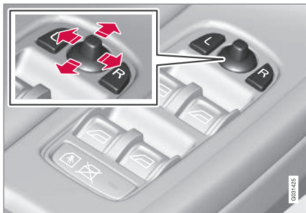
Ovládací prvky vnějších zpětných zrcátek.
