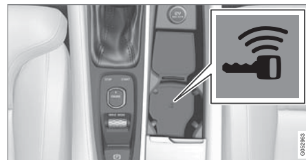
備用讀取器位於中央扶手控制台中。
