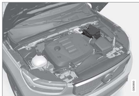
起動電瓶位於引擎室中。
