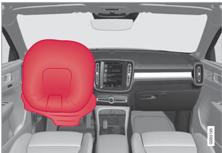
前座駕駛側的方向盤防護氣囊及膝部防護氣囊 1 。
