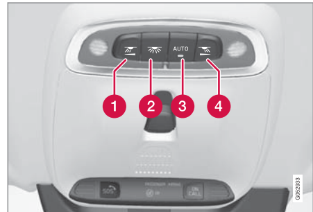
車頂控制台內用於前閱讀燈與乘客室照明的控制裝置。
