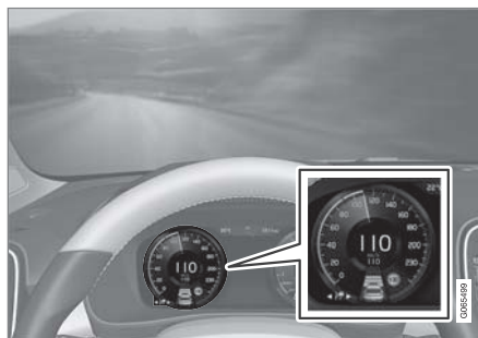
上圖 56 顯示主動式定速巡航控制設定為保持 110 km/h(68 mph)，而且沒有前車可跟隨。
