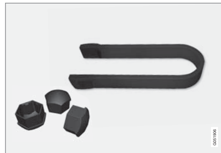
เครื่องมือสำหรับการถอดกุกปิดพลาสติกบนน็อตล้อ
