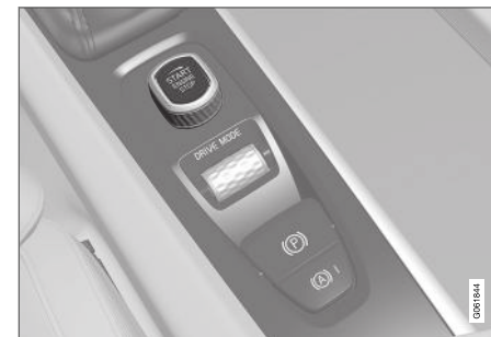
Indító gomb az alagútvezérlőn.
