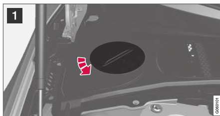
Hűtőfolyadék tágulási tartálya, balkormányos autó.
