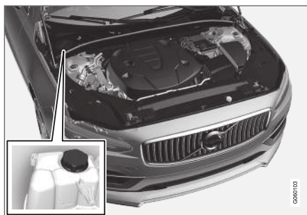
Hűtőfolyadék tágulási tartálya, balkormányos autó.
