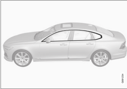
Alkatrészek, amelyek 3,5 és 11,5 pH-érték közötti tisztítószerrel moshatók.
