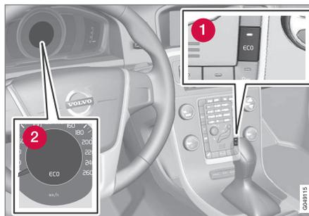
**1** Conexión y desconexión de ECO
