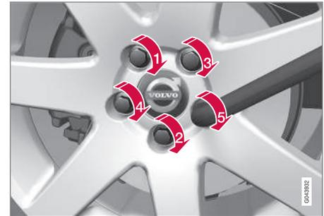
4. Apriete los tornillos de rueda por pares cruzados. Es importante que los tornillos de rueda queden debidamente apretados. Apriete a 140 Nm. Compruebe el apriete con una llave dinamométrica.
