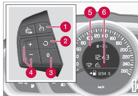
Teclado de volante y cuadro de instrumentos en vehículo **con** limitador de velocidad<sup>4</sup>.
