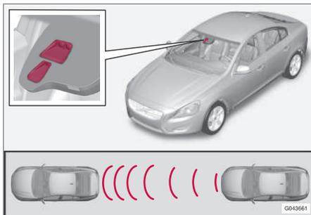
Ventanas del emisor y el receptor del sensor láser<sup>14</sup>.
