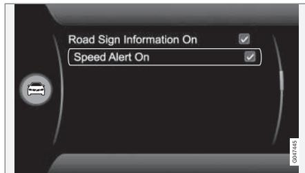
El conductor puede optar por recibir una advertencia en caso de rebasar el límite de velocidad vigente en 5 km/h (5 mph) o más. La advertencia se presenta a través del parpadeo temporal del símbolo con el límite de velocidad aplicable al superarse ésta. El sistema puede conectarse y desconectarse en el sistema de menús **MY CAR**. Para una descripción del sistema de menús, véase MY CAR (p. 116).
