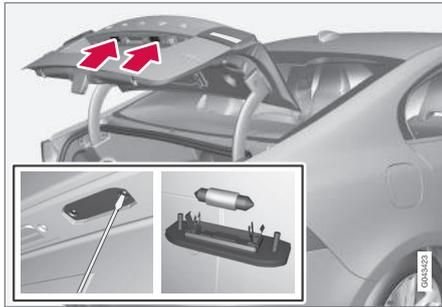
1. Suelte los tornillos con un destornillador.
