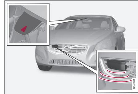
Sensor de cámara y de radar<sup>22</sup>.
