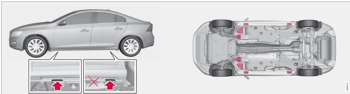
Soportes (flechas) para el gato previsto para el automóvil y puntos de elevación (señalados en rojo).
