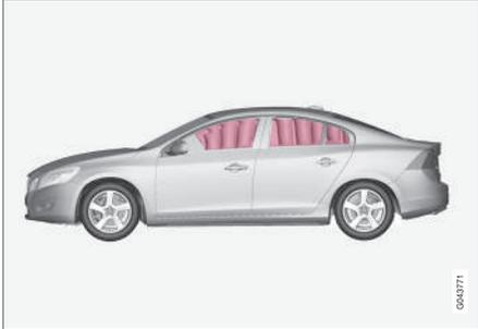
La cortina inflable IC (Inflatable Curtain) forma parte del sistema SIPS (p. 38) y el sistema de airbags (p. 34). Va montado a lo largo de ambos lados del techo interior y contribuye a proteger al conductor y a los pasajeros situados en los asientos exteriores del vehículo. En caso de una colisión de suficiente intensidad, los sensores reaccionan y el airbag de techo lateral se infla.
