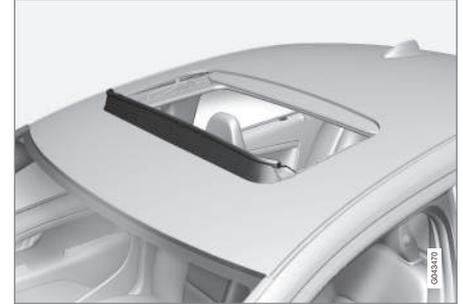
El techo solar está provisto de un deflector de aire que se levanta cuando el techo solar está abierto.
