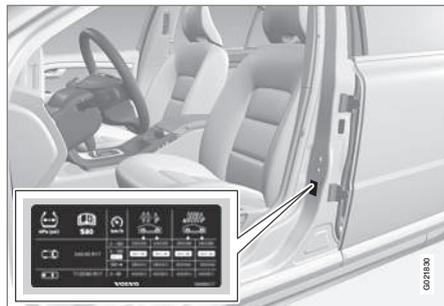
La placa de presión de neumáticos situada en el montante de la puerta del lado del conductor (entre la puerta delantera y la trasera) especifica la presión que deben tener los neumáticos en diferentes condiciones de carga y velocidad. Estos datos se indican también en la tabla de presiones de neumáticos, véase Neumáticos - presiones de inflado aprobadas (p. 452).
