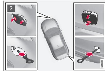
Desmontaje de la tapa delante y detrás.
