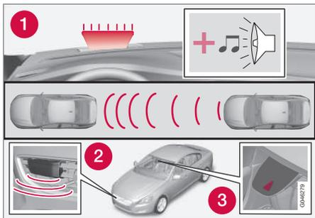
1. El testigo y la señal acústica del aviso de colisión<sup>8</sup>.
