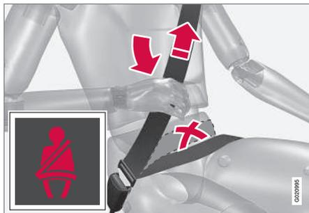
Estire la banda de la cintura tirando de la banda diagonal arriba hacia el hombro. La banda de la cintura debe ir baja (no por encima del abdomen).
