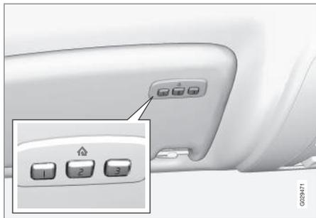
HomeLink®<sup>26</sup> es un mando a distancia programable que puede controlar hasta tres dispositivos diferentes (por ejemplo, la puerta del garaje, el sistema de alarma, la iluminación exterior e interior, etc.) y utilizarse por tanto en lugar de los mandos a distancia correspondientes.
