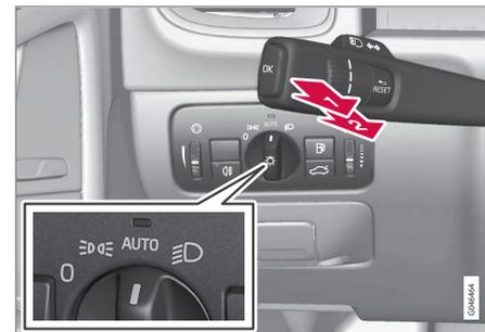
Palanca del volante y mando de las luces.
