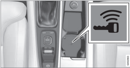
Positie back-uplezer in tunnelconsole.
