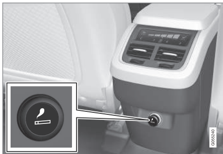
Aansteker in tunnelconsole, tweede zitrij.
