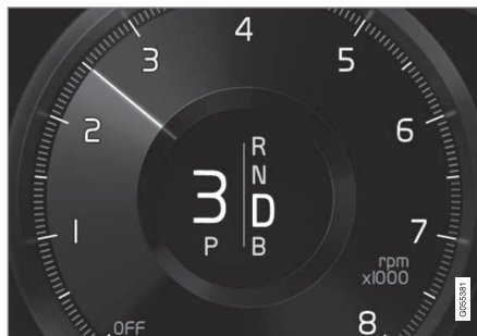
Bestuurdersdisplay bij het schakelen met de stuurpaddles.
