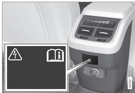
230V-aansluiting in tunnelconsole, tweede zitrij.
