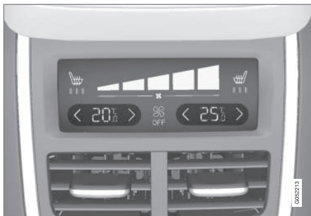
Temperatuurregeling op klimaatpaneel achter op tunnelconsole.
