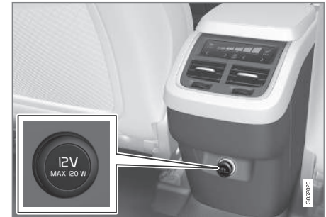
12V-aansluiting in tunnelconsole, tweede zitrij.
