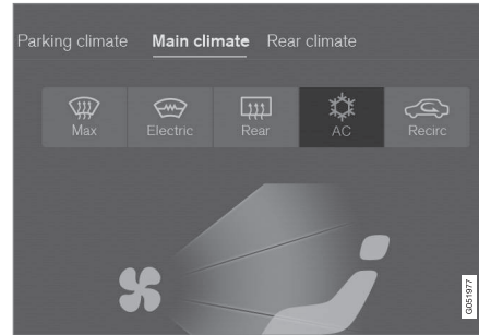
Airconditioningsknop op klimaatscherm.
