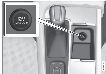
12V-aansluiting in tunnelconsole, voorin.
