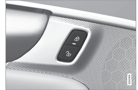
Knop voor vergrendelen/ontgrendelen in voorportier met led.
