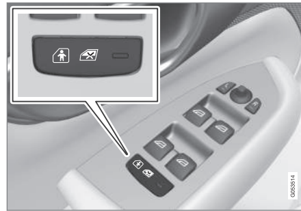
Knop voor elektrische activering/inactivering.
