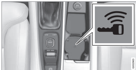
Positie back-uplezer in de tunnelconsole.
