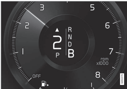
Schakelindicator op het bestuurdersdisplay 2 .
