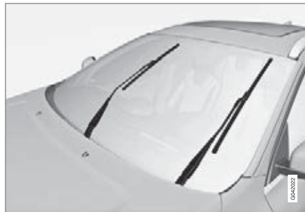
位於維修位置的雨刷片。
