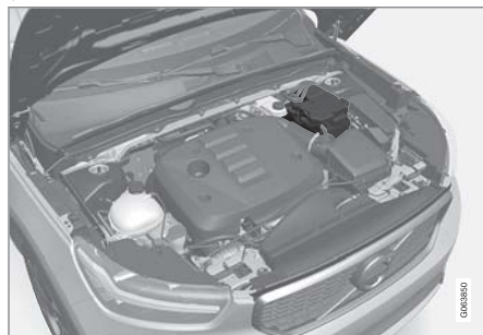
起動電瓶位於引擎室中。
