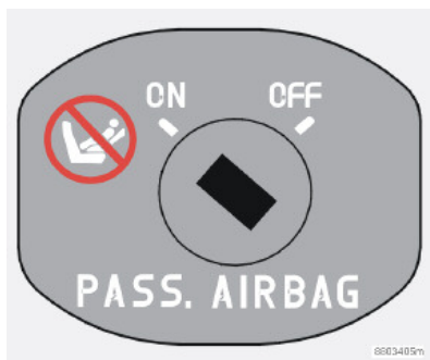
Conmutador para SRS en posición ON.
