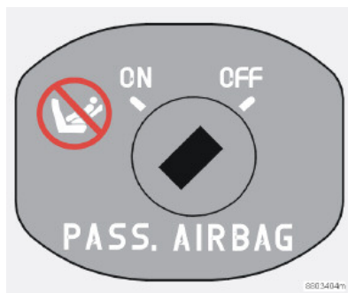
Conmutador para SRS en posición OFF.
