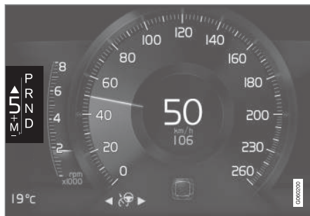
Pavarų perjungimo indikatorius 8 colių vairuotojo ekrane, automobilyje su didele pavarų perjungimo svirtimi.
