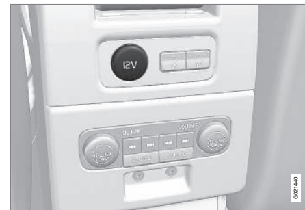
12 V-uttak i tunnellkonsoll, baksete.
