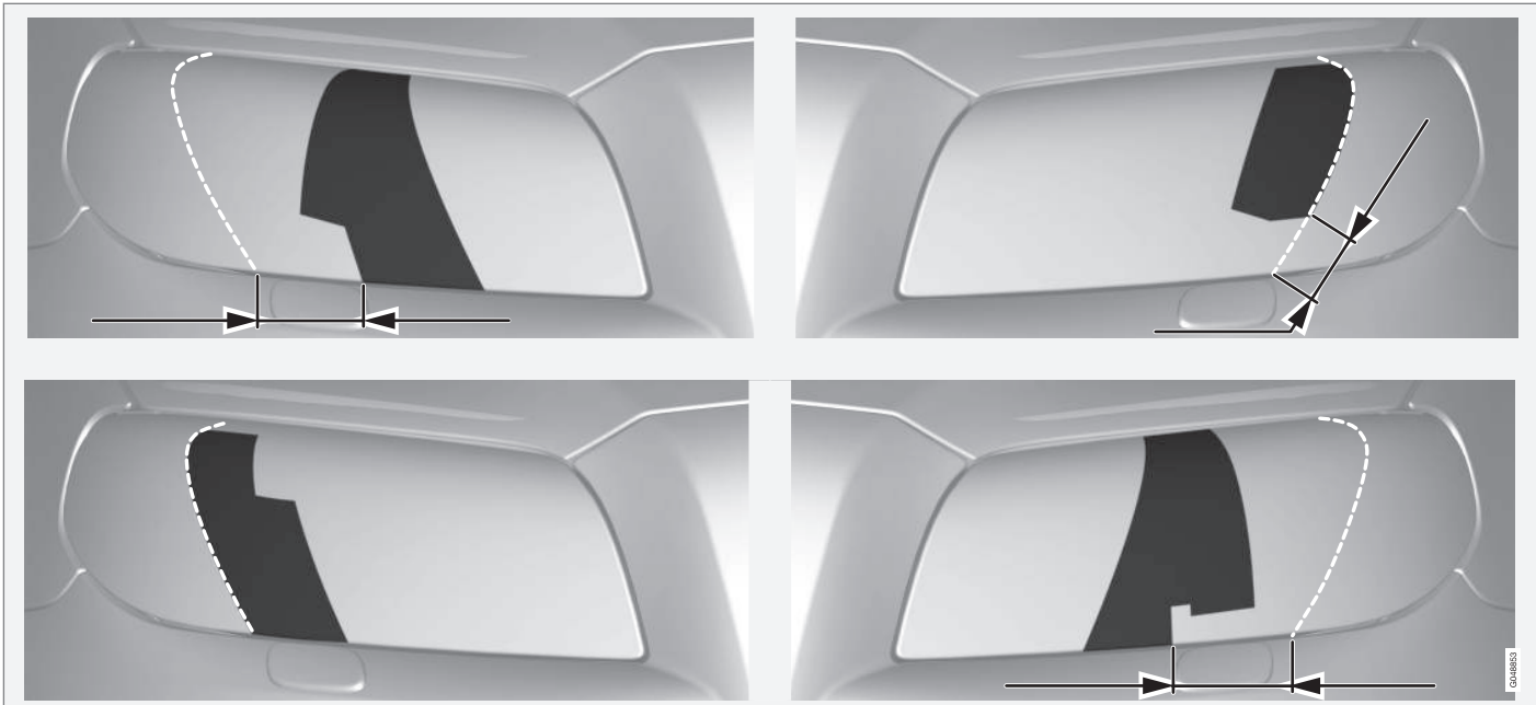
Øverste rad: Bil med venstreratt, malene A og B. Nederste rad: Bil med høyerratt, malene C og D.
