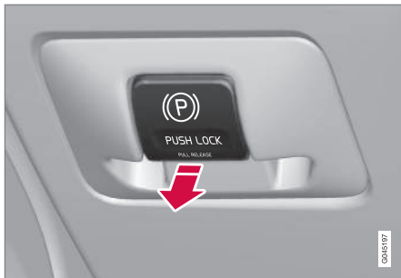
Parkeringsbremsbryter - løs bremsen.
