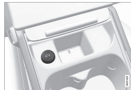
12 V-uttak i tunnellkonsoll, forsete.
