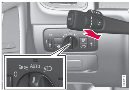
Rattspake og lysbryter i posisjon AUTO .
