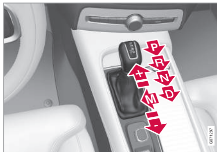
Overzicht grote schakelhendel en schakelstanden.
