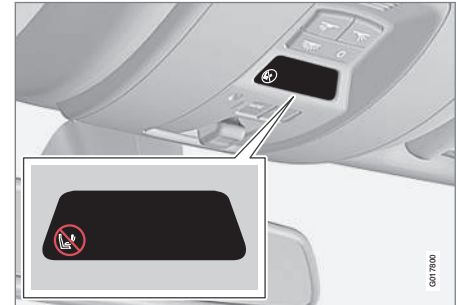
Ενδεικτική λυχνία που υποδεικνύει ότι ο αερόσακος συνοδηγού είναι ενεργοποιημένος.
