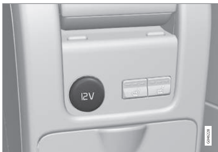
Ρευματοδότης 12 V στην επιμήκη κονσόλα, πίσω κάθισμα.
