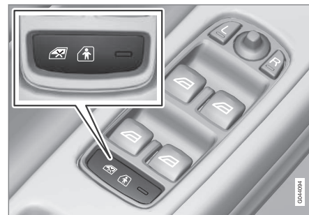
Πλαίσιο χειριστηρίων στην πόρτα του οδηγού.
