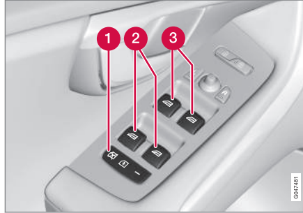
Sürücü kapısı kontrol paneli.
