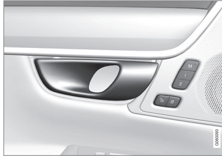
Openingsgreep voor alternatieve ontgrendeling op zijportier 10 .
