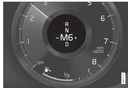
Schakelindicator op 12 inch bestuursdisplay voor de kleine schakelhendel*.
