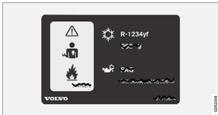
3 Наклейка системы кондиционирования воздуха с хладагентом R1234yf.
