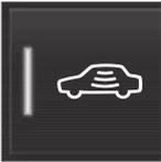
Pressione o botão **Proteção reduzida** na visualização de função do visor central para desativar temporariamente a função trava dupla.
