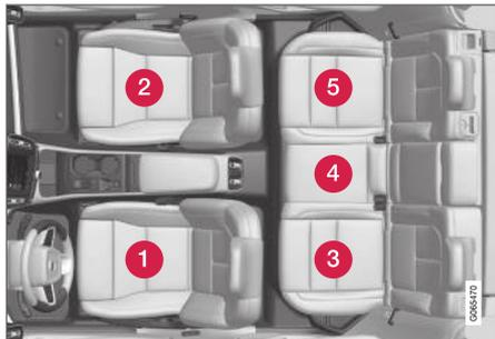
Posições dos bancos em veículo com volante à esquerda.
