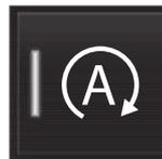
Desligue com o botão de função **Partida/Parada** na visualização de função do visor central. Com a função desligada, a indicação no botão está apagada.
