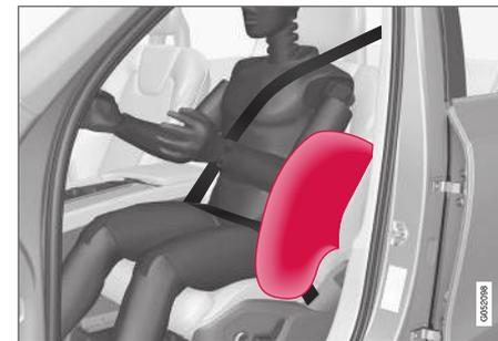
Os airbags laterais são instalados nas estruturas externas do encosto nos bancos dianteiros para ajudar a proteger o motorista e o passageiro dianteiro.
