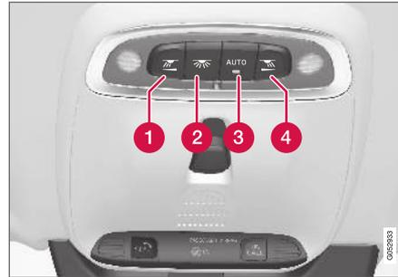
Controle no console do teto para as lâmpadas de leitura dianteiras e a iluminação interna.
