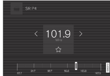
Ao trocar para sintonização manual, o rádio não muda mais de frequência automaticamente quando a recepção está fraca.
