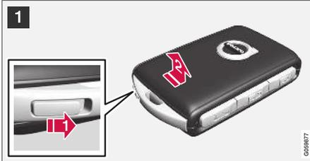
**1** Segure a chave do controle remoto com a frente visível e o logo da Volvo para o lado direito. Deslize o botão na extremidade de baixo do anel da chave para a direita. Leve a proteção lateral dianteira alguns milímetros para cima.
