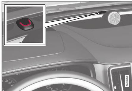
O indicador de travamento e de alarme exibe no painel de instrumentos o estado do sistema de travamento:
