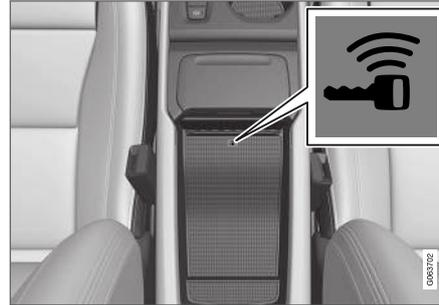
Coloque o controle remoto no símbolo da chave no leitor que está no compartimento de armazenamento do console de túnel.
