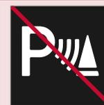
Preste muita atenção ao andar na marcha à ré quando esse símbolo for exibido se um reboque, um suporte para bicicleta ou similar estiver montado e conectado eletricamente ao veículo.
