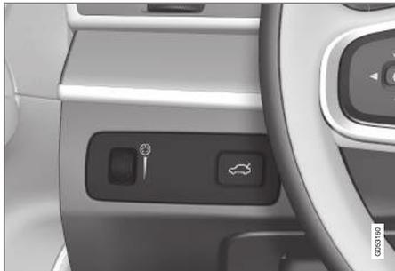
O seleto rotativo (à esquerda) para ajuste da intensidade da luz interior.
