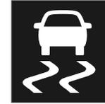
Quando a Assistência de estabilidade do reboque (TSA) está funcionando, o símbolo ESC pisca no visor do motorista.
