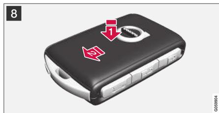
**8** Gire a chave do controle remoto e reinstale a proteção lateral dianteira pressionando-a até ouvir um clique.
