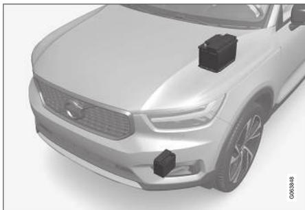
A bateria de apoio está na parte inferior do compartimento do motor. Aqui também é ilustrada a bateria de partida (em cima).
