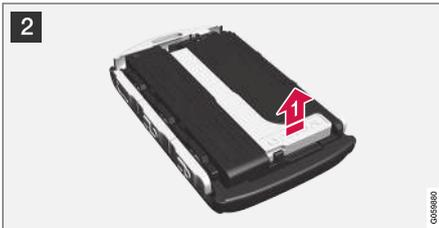
**2** Destaque a lâmina da chave inclinando-a para cima.
