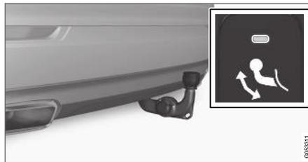
Desloque a barra de reboque para a sua posição final onde este fixa e bloqueia - a luz indicadora assume luz fixa laranja.
