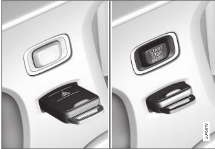
Spínací skříňka s vytaženým/zasunutým dálkovým ovladačem.
