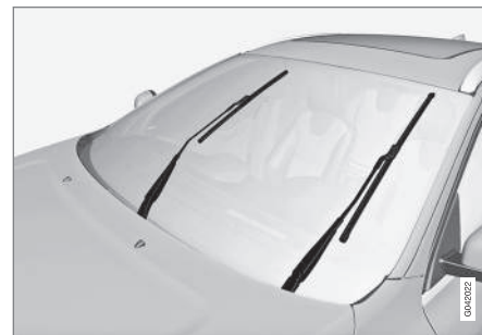
Balais d'essuie-glace en position d'entretien.
