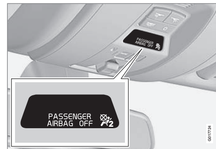
Az utaslégszák kiiktatott állapotát mutató visszajelző.
