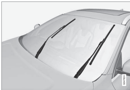
Escobillas de limpiaparabrisas en posición de servicio.
