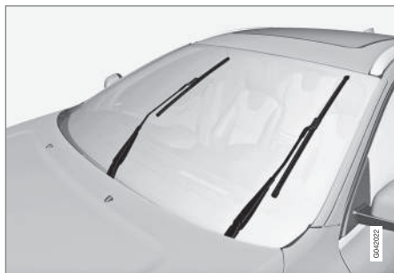
Escobillas de limpiaparabrisas en posición de servicio.
